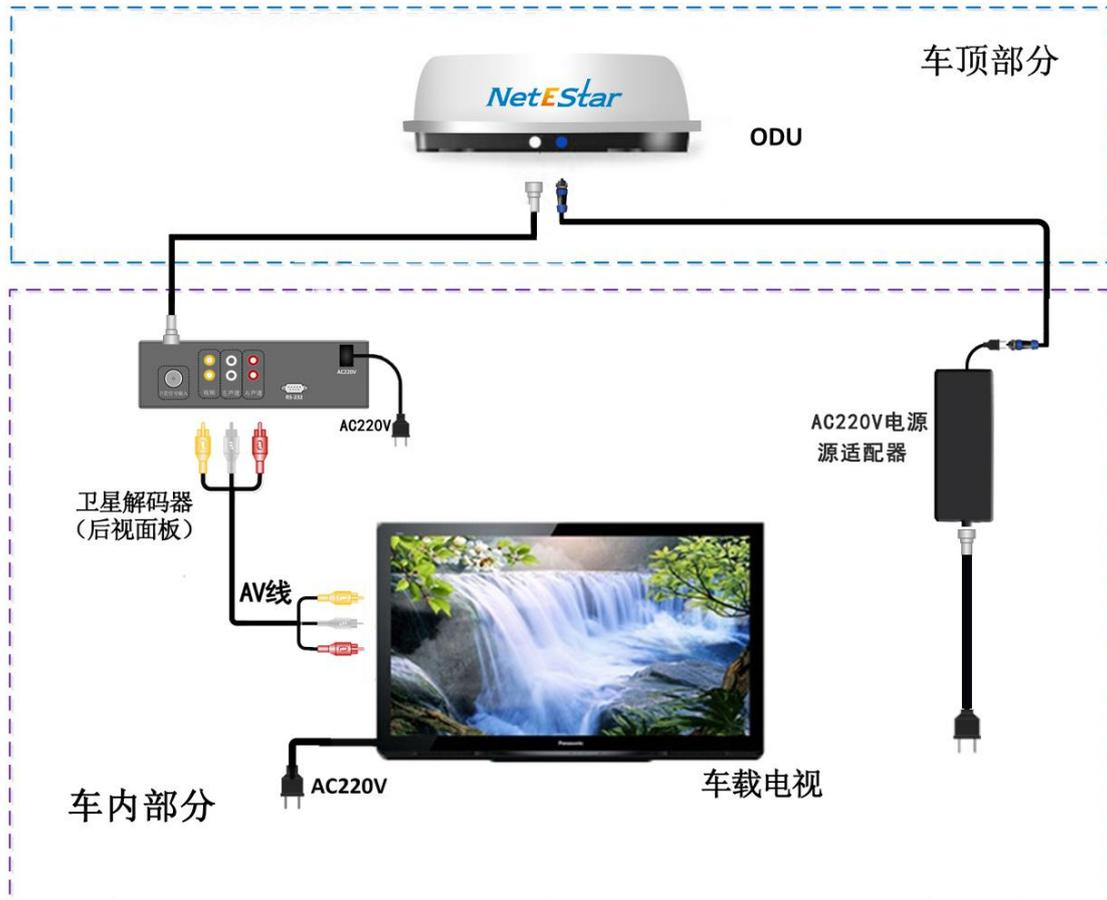
图 11 CSA-2 设备连接示意图
