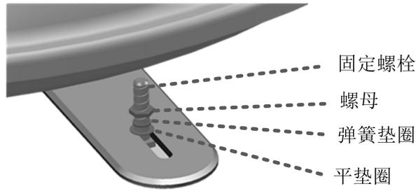
图 9 安装示意图
