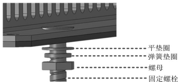
图 10 安装示意图
